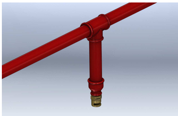
Rys. 2 Pionowa – strumień wody rozpylony równoległe do podłoża
