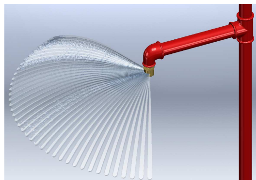
Rys. 2 Pionowa – strumień wody rozpylony równoległe do podłoża
