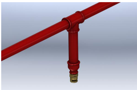
Rys. 2 Pionowa – strumień wody rozpylony równolegle do podłoża
