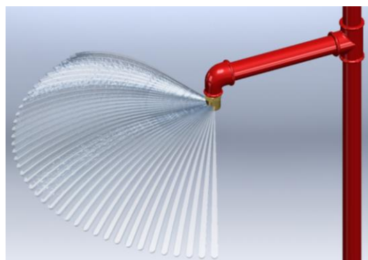
Rys. 2 Pionowa – strumień wody rozpylony równolegle do podłoża
