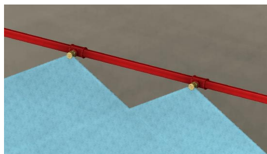
Rys. 3 Pozioma – strumień wody rozpylony prostopadle do podłoża
